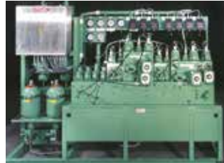
Ventilstand für Brammenstranggussanlage
