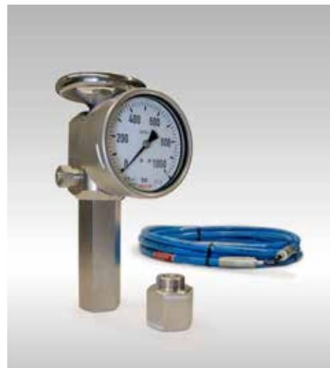
Die FPU-2 wurde speziell für Hochdruckanwendungen entwickelt. Ebenso, wie die FPU-1, ist die FPU-2 universell einsetzbar. Auf HYDAC Kolben- und Membranspeicher kann sie direkt aufgeschraubt werden, um die Speicher zu füllen und/oder zu prüfen. Für die Anwendung mit einem Blasenspeicher ist der Hochdruckadapter A3H zu verwenden. Dieser ist standardmäßig nicht im Lieferumfang enthalten.
