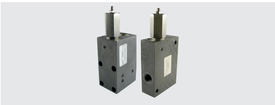
HYDAC Speicherladeventile regeln, innerhalb eines einstellbaren Schaltbereichs, die Ladung des Hydro-Speichers. Durch die Kombination mit einem Hydro-Speichers können Pumpen und Motoren an ölhydraulischen Anlagen mit schwankendem Volumenstrombedarf kleiner dimensioniert werden. Dies spart Kosten und Energie - eine unnötige Wärmeentwicklung wird somit vermieden.
