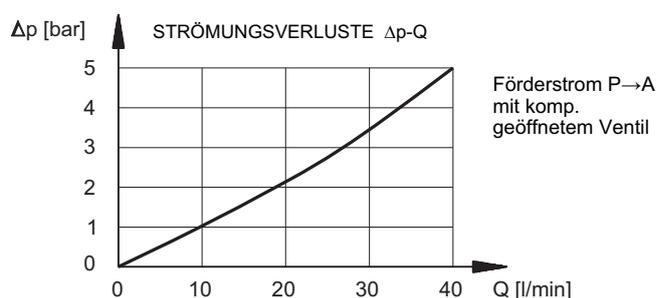
**HINWEIS:** Was den Fluss A→P mit geschlossenem Ventil betrifft, fügen Sie zu den in dem Diagramm angegebenen Werten den Öffnungsdruck (0,5 bar) hinzu.
